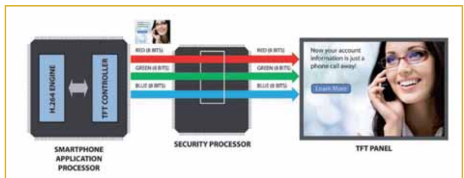
Fig. 2 – In modalità normale il processore di sicurezza agisce alla stregua di un dispositivo pass-through
